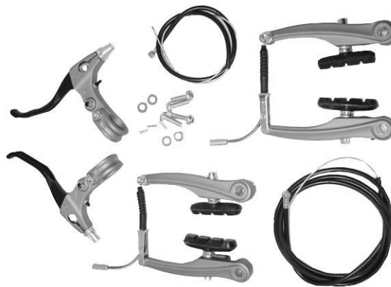
Figura 1 – Exemplo de conjunto de freio de bicicleta de uso adulto.
